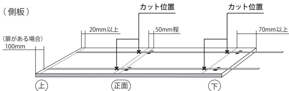
位置を合わせてカットする箇所に印を付け、付属の金ノコでカットします。
